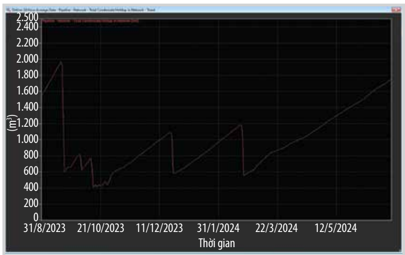
Hình 6. Giản đồ sản phẩm lỏng tích lũy hình thành trong đường ống.
