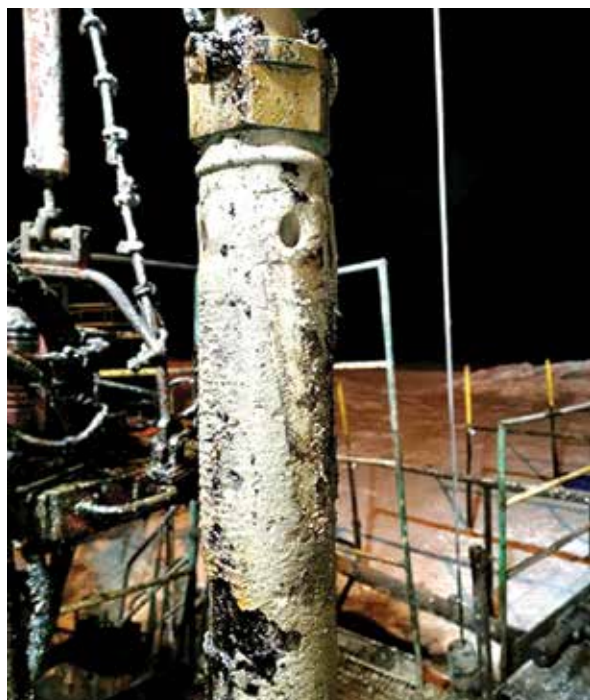
Hình 12. Cặn muối bám trên thân giếng và mẫu cặn thu thập được.
