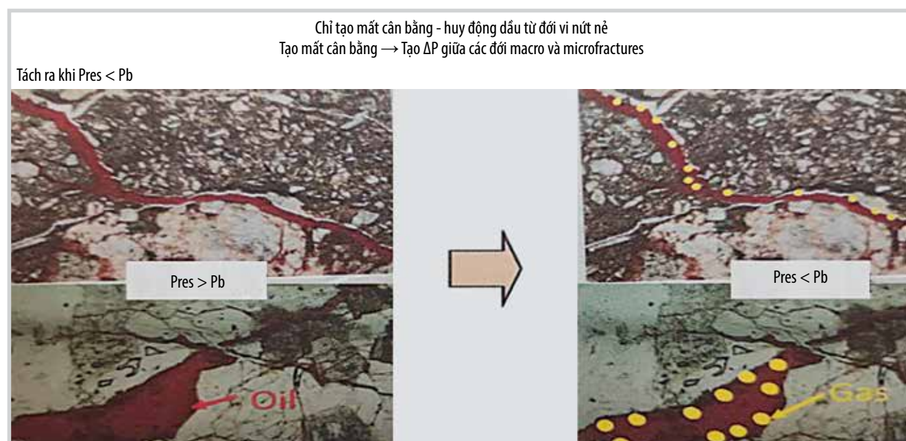
Hình 3. Giảm áp suất để tạo ra môi trường mất cân bằng.
