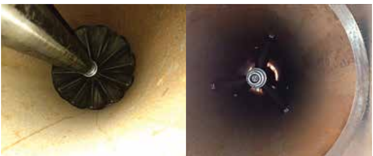
Hình 5. Giỏ xi măng sau khi kích hoạt.
