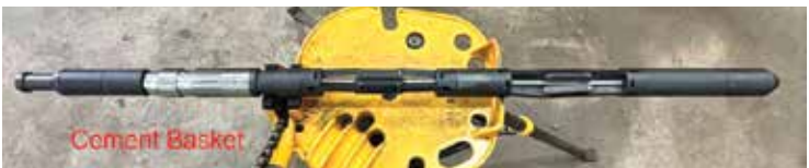
Hình 4. Cấu tạo thiết bị cement basket (minh họa và thực tế).
